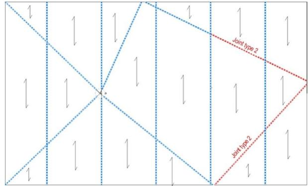
Plan des joints avec technologie TS3
