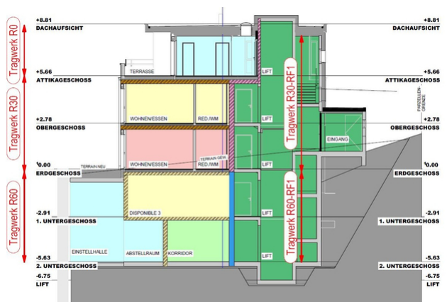
Coupe avec les différents compartiments coupe-feu
