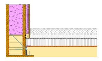
Detail Anschluss Decke an Träger bei auskragender Attika
